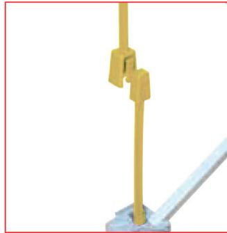
Die Struktur stets am Rahmen anheben – niemals an den Verbindungselementen
